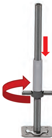
Einstecken der Fußplatten
