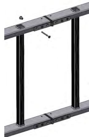
3. Einbau der Faltrahmenverriegelung und Sicherung mit einer selbstsichernden Mutter M6.
