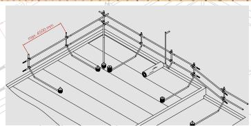
Das nach oben klappbare Ballastierungsrohr schafft Freiraum bis zur Dachkante. Für bequemes und sicheres Arbeiten.
